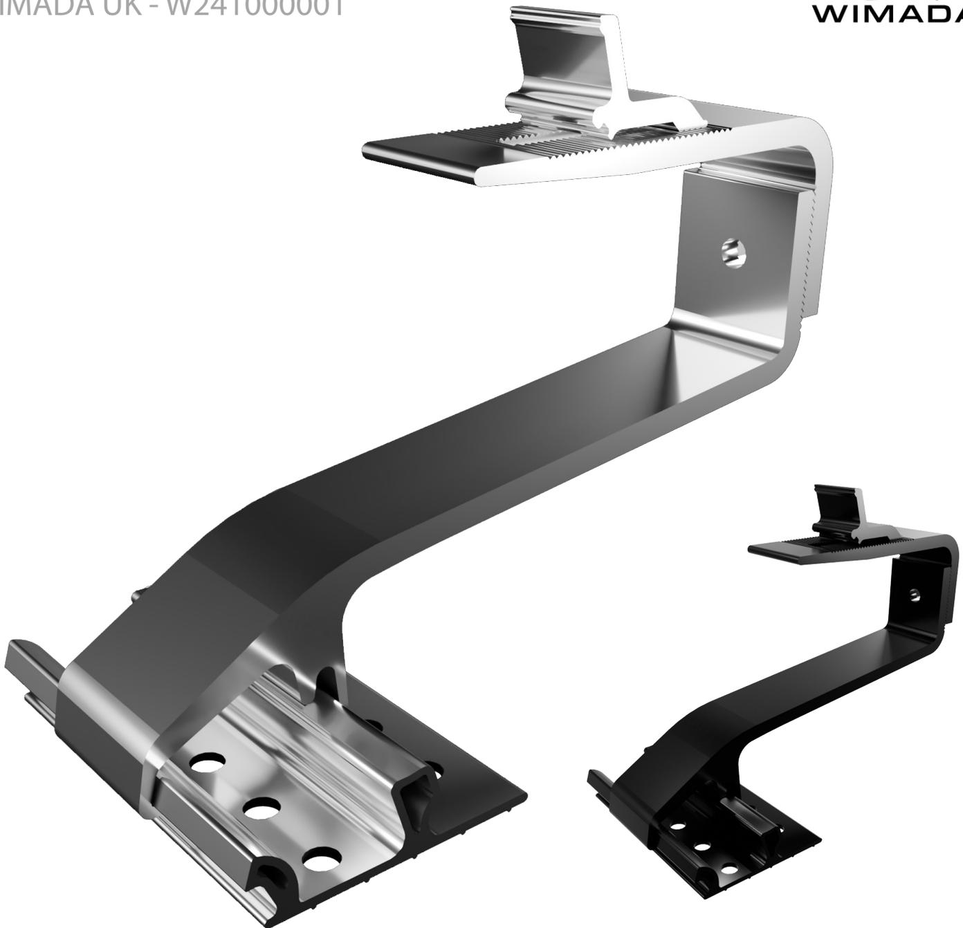
Der Dachhaken ST1 VARIO dient zur Befestigung von Solarpanelen auf Steildächern. Dank der zwei Langlöcher lassen sich Höhe und Position des Dachhakens variabel anpassen. Die Grundschiene wird durch Klemmung befestigt.
